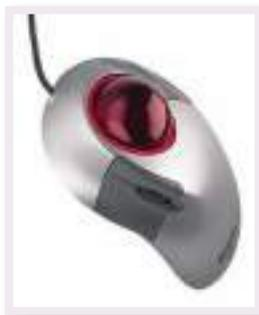
Difere do rato, que tem que ser movimentado sobre uma superfície plana. O trackball utiliza-se sem se mover numa superfície. A esfera de grandes dimensões que apresenta em cima é manipulada pelo utilizador (com os dedos ou com a palma da mão) para controlar o cursor no monitor do computador. De igual modo, os trackballs podem ligar-se ao computador por meio de um cabo ou comunicarem com ele sem fios, em modo wireless. Assumem também formatos e cores variadas.
